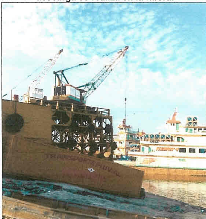
Gráfico N° 1.1.2.25 Vista del muelle fijo de HENRY, se aprecia también que es utilizado para el apoyo de las grúas mientras que la descarga se realiza en la ribera.
