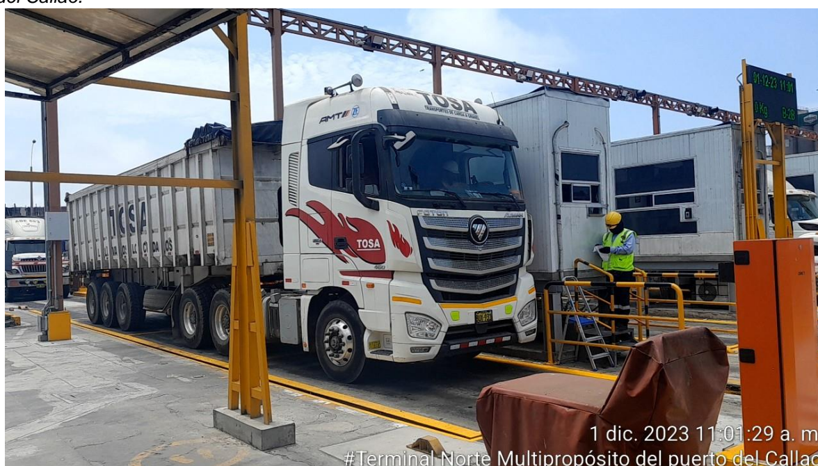
Gráfico 43 Pesaje del camión en la balanza de ingreso del Terminal Portuario Multipropósito del puerto del Callao.
