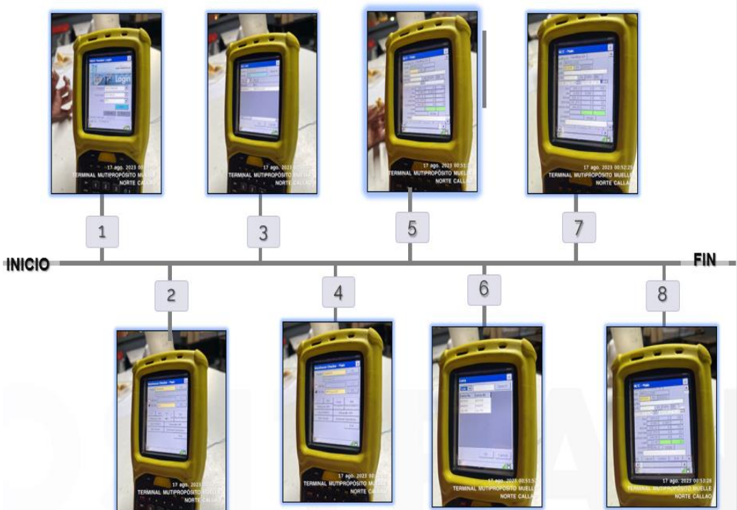
Gráfico 49 Proceso de tarja de la carga sólida a granel despachada.
