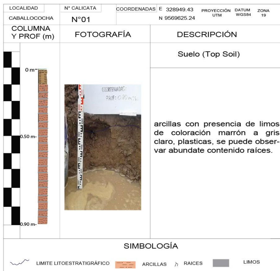
Figura 4.1-43: Formato de descripción de calicata C-1-CAB Fuente: Imagen Proyecto trabajo de campo, elaboración propia.
