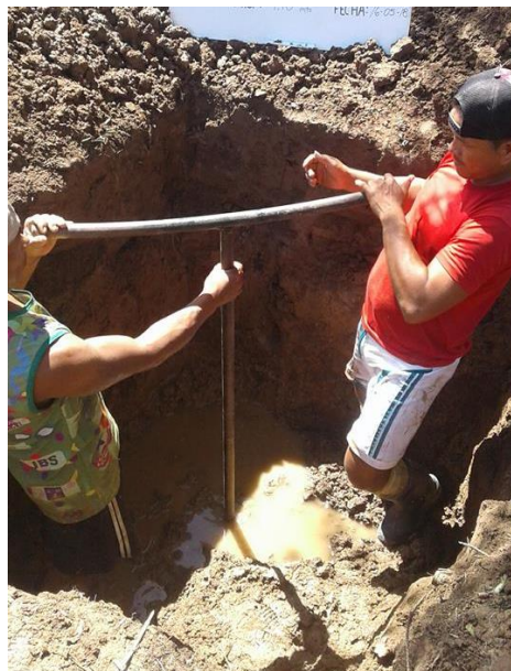
Figura 4.1-47: Excavación de la calicata 02, con ayuda de una barrena manual para llegar hasta los 2.10m de profundidad.
