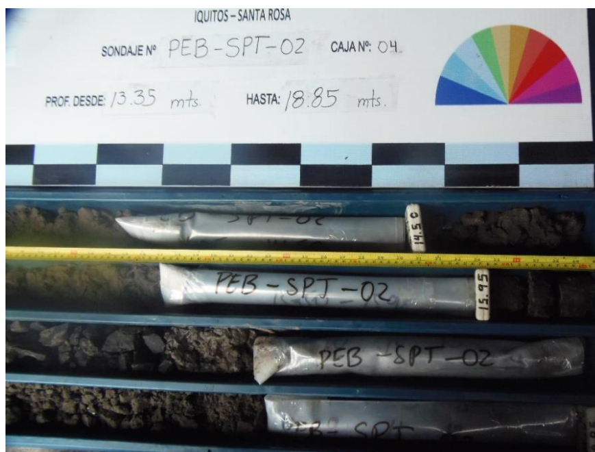
Figura 4.1-21: Caja de muestras del sondaje SPT-2-PEB, realizado en la localidad de Pebas, desde 13.35m hasta 18.85m.
