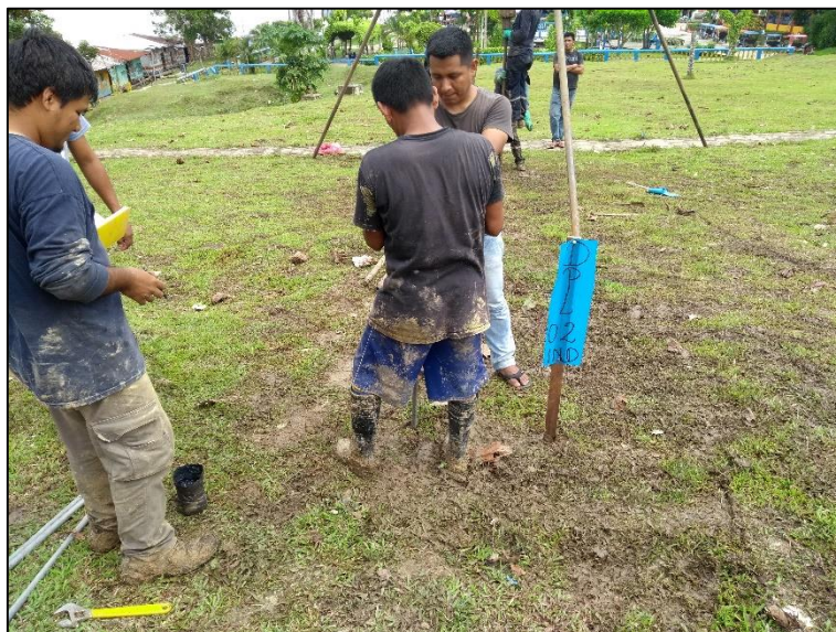
Figura 3.2-17: Ensayo DPL, DPL-2-IND Fuente: Elaboración propia. (Mayo 2018).
