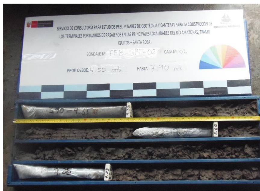
Figura 4.1-19: Caja de muestras del sondaje SPT-2-PEB, realizado en la localidad de Pebas, desde 4.00m hasta 7.90m.
