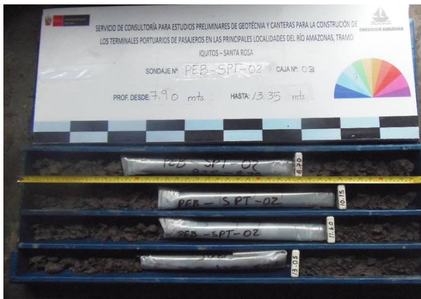
Figura 4.1-20: Caja de muestras del sondaje SPT-2-PEB, realizado en la localidad de Pebas, desde 7.90m hasta 13.35m.
