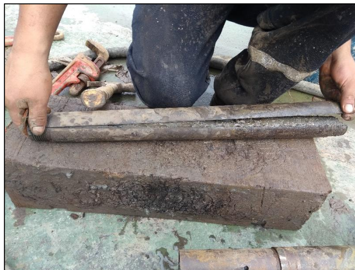
Figura 3.2-21: Recuperación de muestra con tubo de caña partida. Fuente: Elaboración propia. (Mayo 2018).
