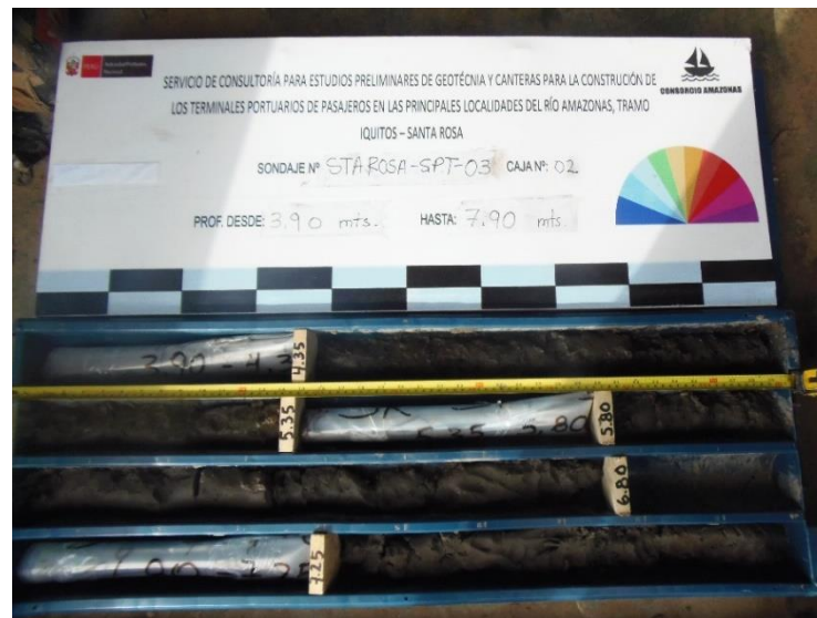
Figura 4.1-71: Caja de muestras del sondaje SPT-3-SAR, realizado en la localidad de Santa Rosa, desde 3.90m hasta 7.90m.
