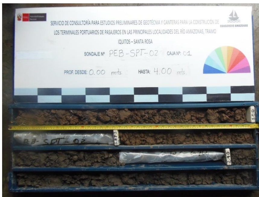
Figura 4.1-18: Caja de muestras del sondaje SPT-2-PEB, realizado en la localidad de Pebas, desde 0.00 m hasta 4.00m.
