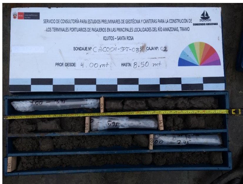
Figura 4.1-52: Caja de muestras del sondaje SPT-3-CAB, realizado en la localidad de Caballococha, desde 4.00m hasta 8.50m.
