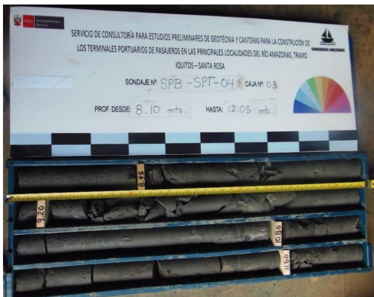
Figura 4.1-35: Caja de muestras del sondaje SPT-4-SPA, realizado en la localidad de San Pablo, desde 8.10m hasta 12.05m.
