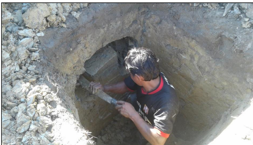
Figura 3.2-27: Extracción de muestra inalterada en bloque de la calicata C-1N-SPA Fuente: Elaboración propia. (Mayo 2018).
