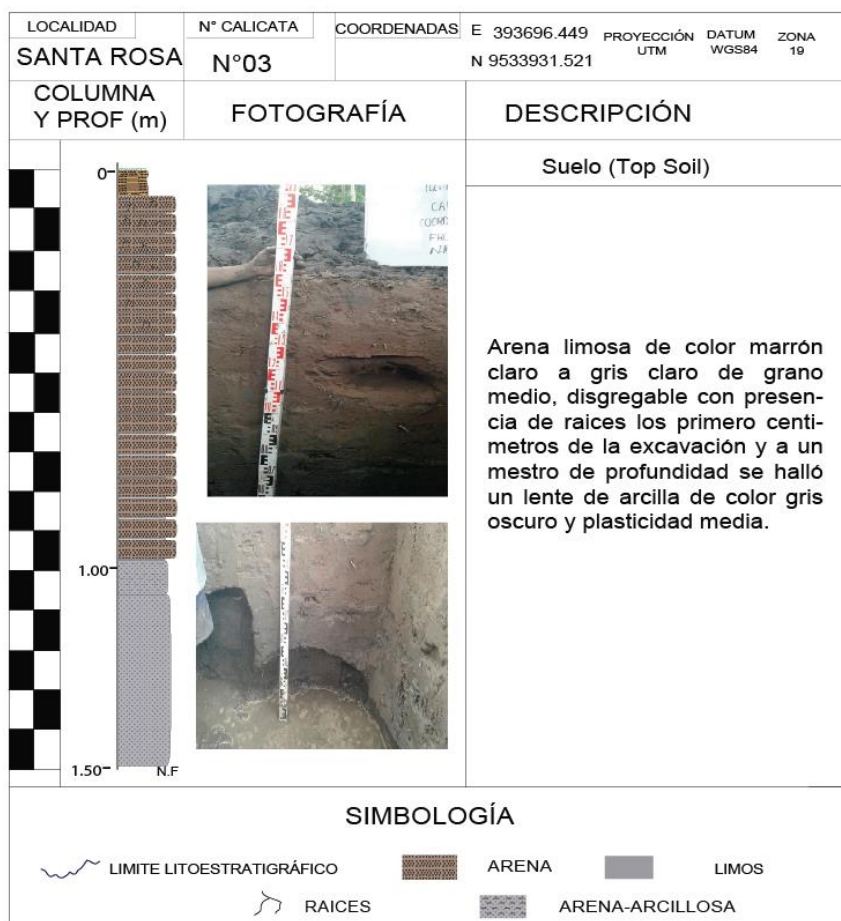
Figura 4.1-63: Formato de descripción de calicata C-3-SAR Fuente: Imagen Proyecto trabajo de campo, elaboración propia.
