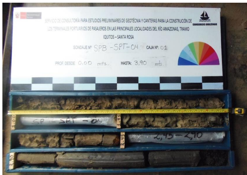
Figura 4.1-33: Caja de muestras del sondaje SPT-4-SPA, realizado en la localidad de San Pablo, desde 0.00m hasta 3.90m.
