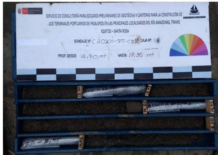
Figura 4.1-54: Caja de muestras del sondaje S-1, realizado en la localidad de Cabalococho, desde 12.70m hasta 17.30m. Fuente: Imagen Proyecto trabajo de campo
