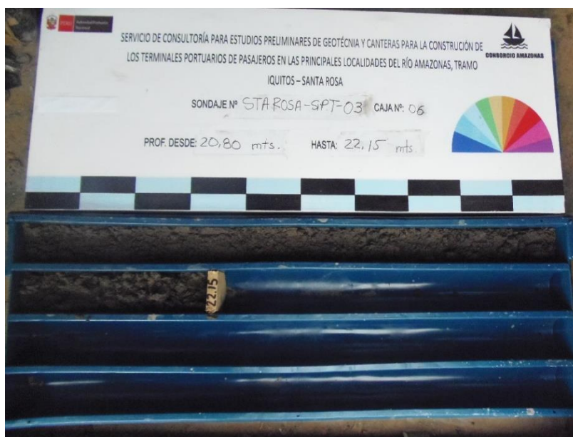
Figura 4.1-75: Caja de muestras del sondaje SPT-3-SAR, realizado en la localidad de Santa Rosa, desde 20.80m hasta 22.15m.
