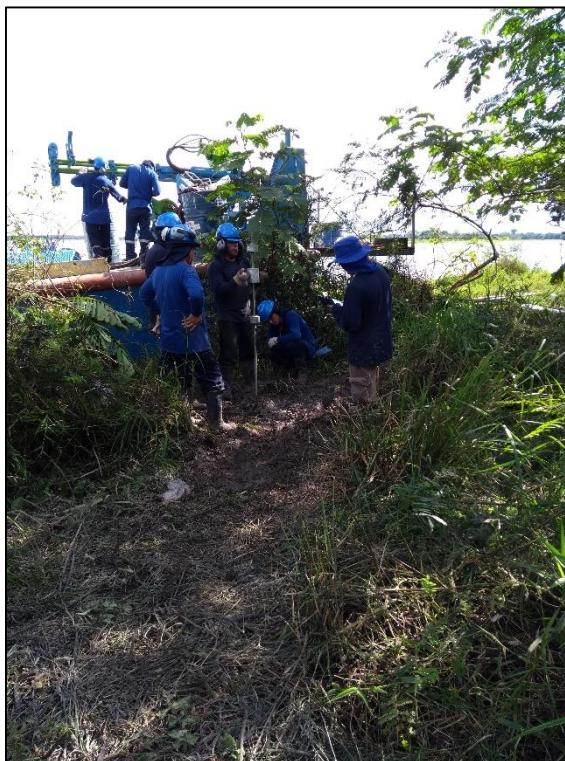
Figura 3.2-22: Ensayo DPL, DPL-2-PEB Fuente: Elaboración propia. (Mayo 2018).
