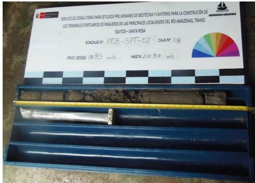
Figura 4.1-22: Caja de muestras del sondaje SPT-2-PEB, realizado en la localidad de Pebas, desde 18.85m hasta 20.30m.
