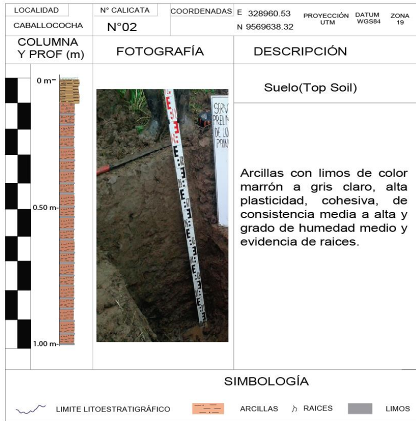
Figura 4.1-44: Formato de descripción de calicata C-2-CAB Fuente: Imagen Proyecto trabajo de campo, elaboración propia.
