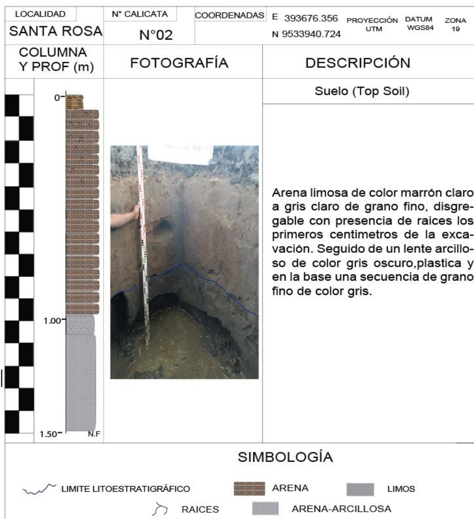
Figura 4.1-62: Formato de descripción de calicata C-2-SAR Fuente: Imagen Proyecto trabajo de campo, elaboración propia.
