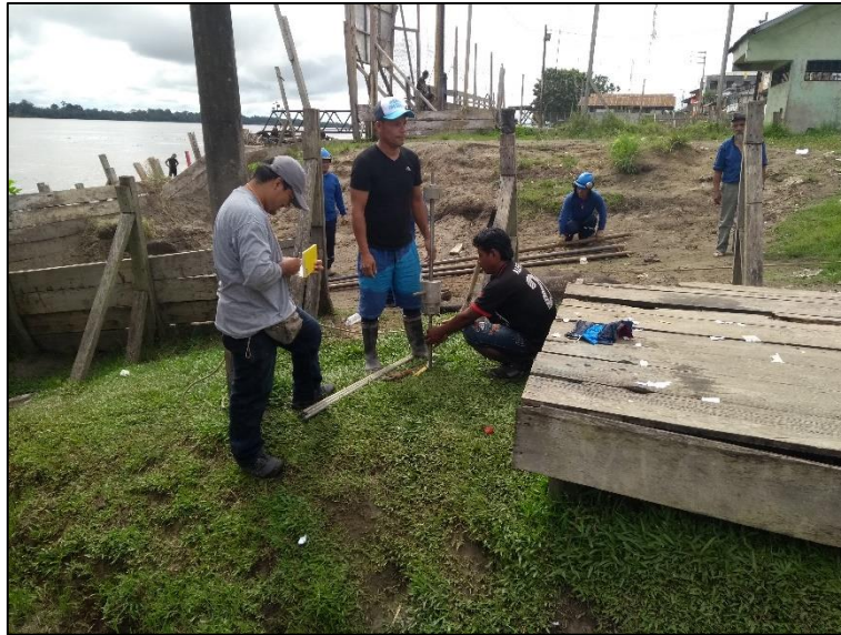
Figura 3.2-25: Ensayo DPL. DPL-1-SPA Fuente: Elaboración propia. (Mayo 2018).
