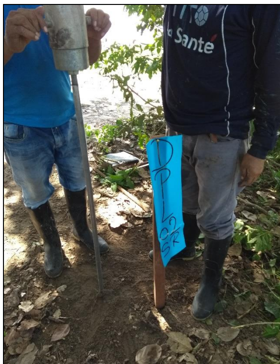
Figura 3.2-33: Ensayo DPL. DPL-2-SAR
