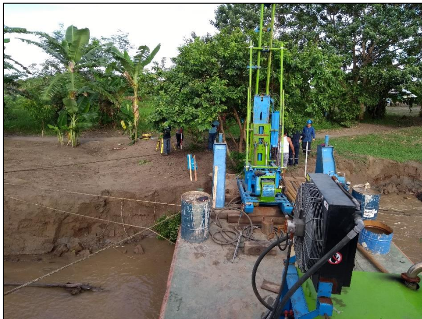
Figura 3.2-32: Ensayo de penetración estándar SPT, SPT-3-SAR Fuente: Elaboración propia. (Mayo 2018).
