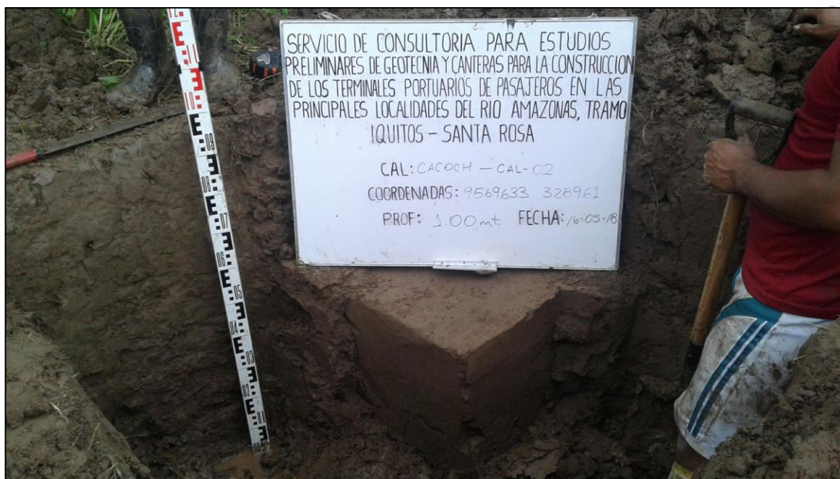
Figura 3.2-31: Desmoronamiento del bloque de suelo en la calicata C-2-CAB Fuente: Elaboración propia. (Mayo 2018).
