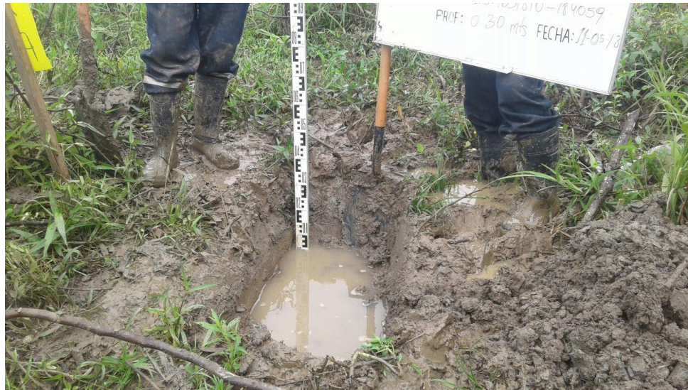
Figura 4.1-14: Excavación de la calicata C-2-PEB Fuente: Imagen Proyecto trabajo de campo.
