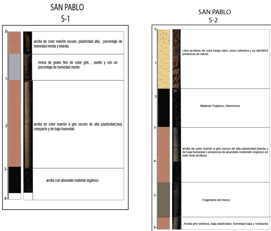
Figura 4.1-29: Descripción litoestratigráfica y medición de espesores de las muestras extraídas del sondaje SPT-1-SPA y SPT-2-SPA de la localidad de Indiana.
